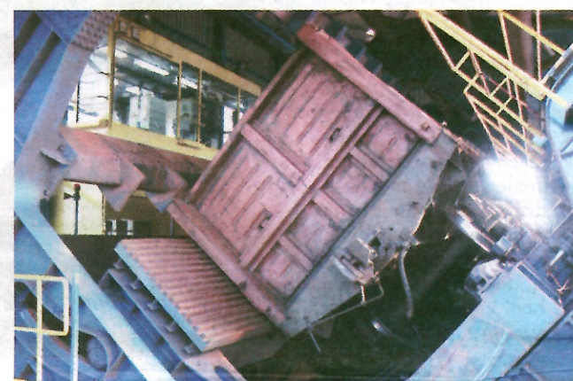
Obsah širokorozchodného vozňa sa vyprázdni jeho otočením o 175 stupňov. Celý proces sa v súčasnosti deje za „zavretými dverami“, aby sa eliminovala prašnosť.
