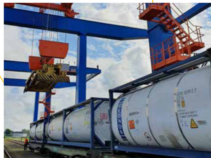
Súčasná maximálna prekládková kapacita terminálu je 430 TEU za 24 hodín, čo predstavuje pri nepretržitej prevádzke približne 3 200 vlakov za rok.
